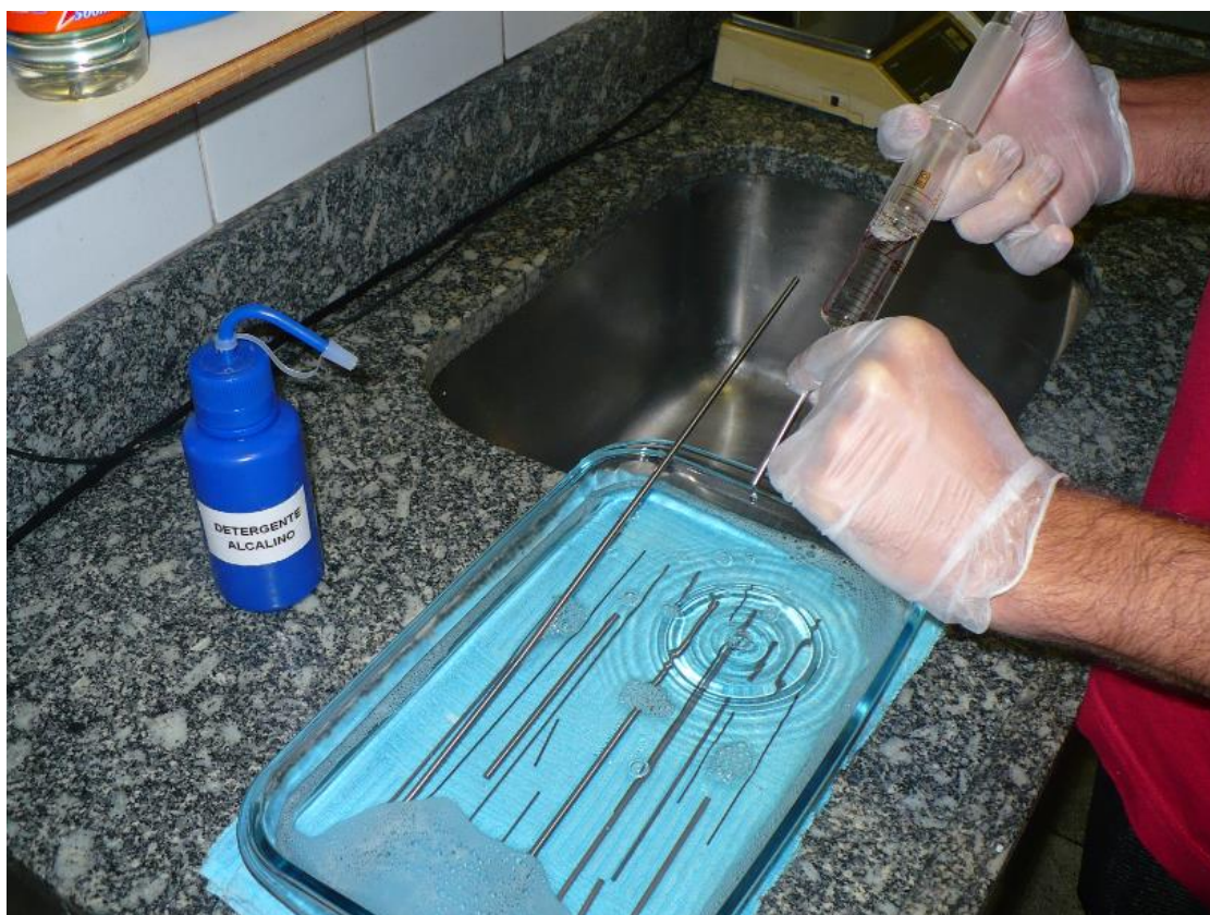
Figura 13: Limpeza de tubos de condutâncias a serem estudadas.
