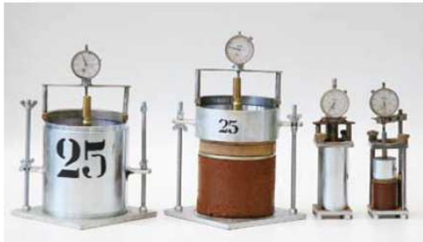
Figura 3.2 - Ensaio de CBR e Mini CBR para a obtenção da Expansão Fonte: NOGAMI e VILIBOR (2009)
