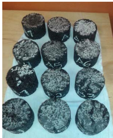
Figura 3.8: CP's levemente enxugados após a pesagem hidrostática Fonte: PRÓPRIA (2014)
