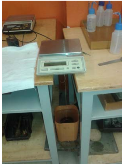
Figura 3.7: Pesagem hidrostática Fonte: PRÓPRIA (2014)
