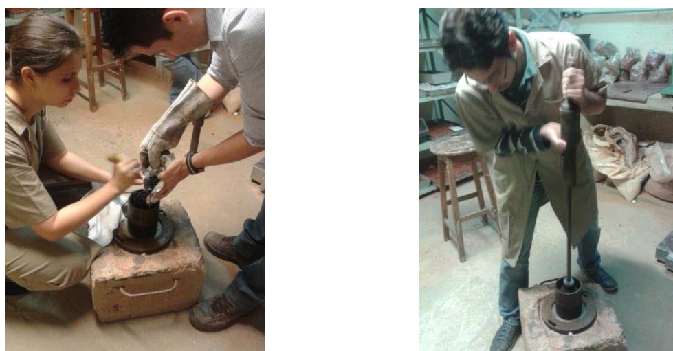
Figura 3.6: Preparação do corpo de prova à esquerda e compactação à direita Fonte: PRÓPRIA (2014)
