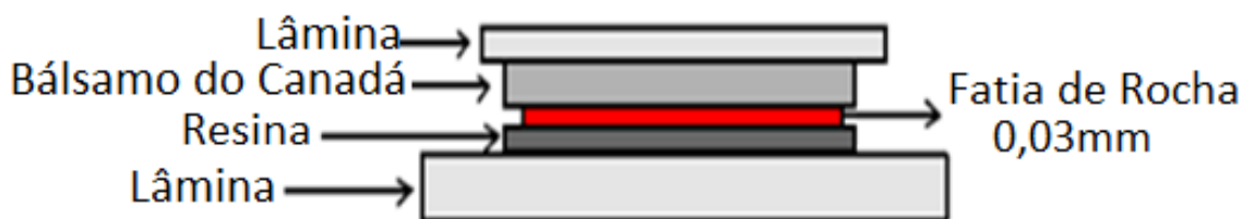
FIGURA 10 – Representação esquemática de uma montagem em lâmina de uma amostra de rocha (Nardy & Machado 2013).
