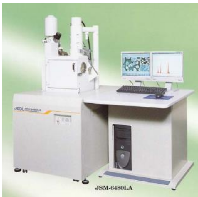
FIGURA 6 – Ilustração de um Microscópio Eletrônico de Varredura acoplado a um EDS (Maliska 2011).
