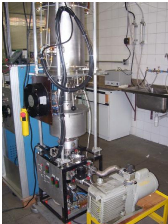
Figura 4 – Forno utilizado para a impregnação do catodo [3].
