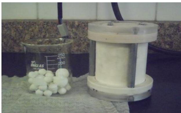
Figura 9 – Pote de Moagem (à direita) e quantidade de esferas de alumina utilizada (à esquerda).
