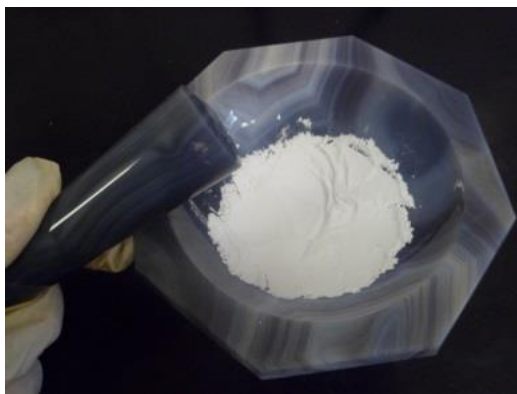
Figura 12 – Textura obtida dos pós após a moagem em almofariz.
