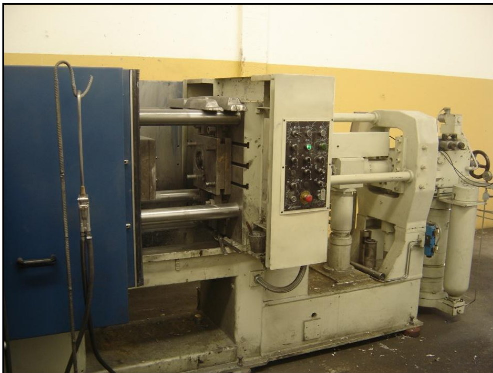
Figura 11 - Célula de produção estudada (Máquina injetora de câmara fria)
