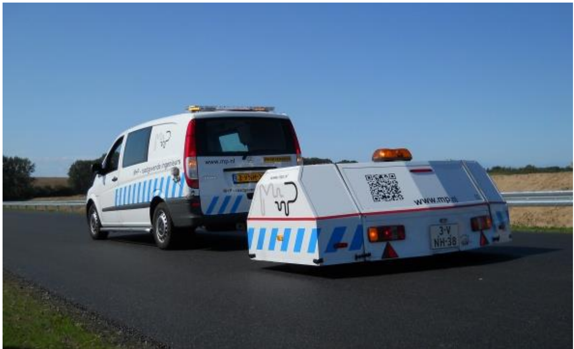
Figura 5.10 – Exemplo de veículo utilizando o método CPX em uma via da Holanda
