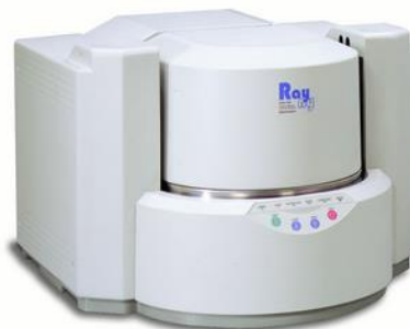
Figura 18: Aparelho Shimadzu EDX-720 utilizado na análise [31].
