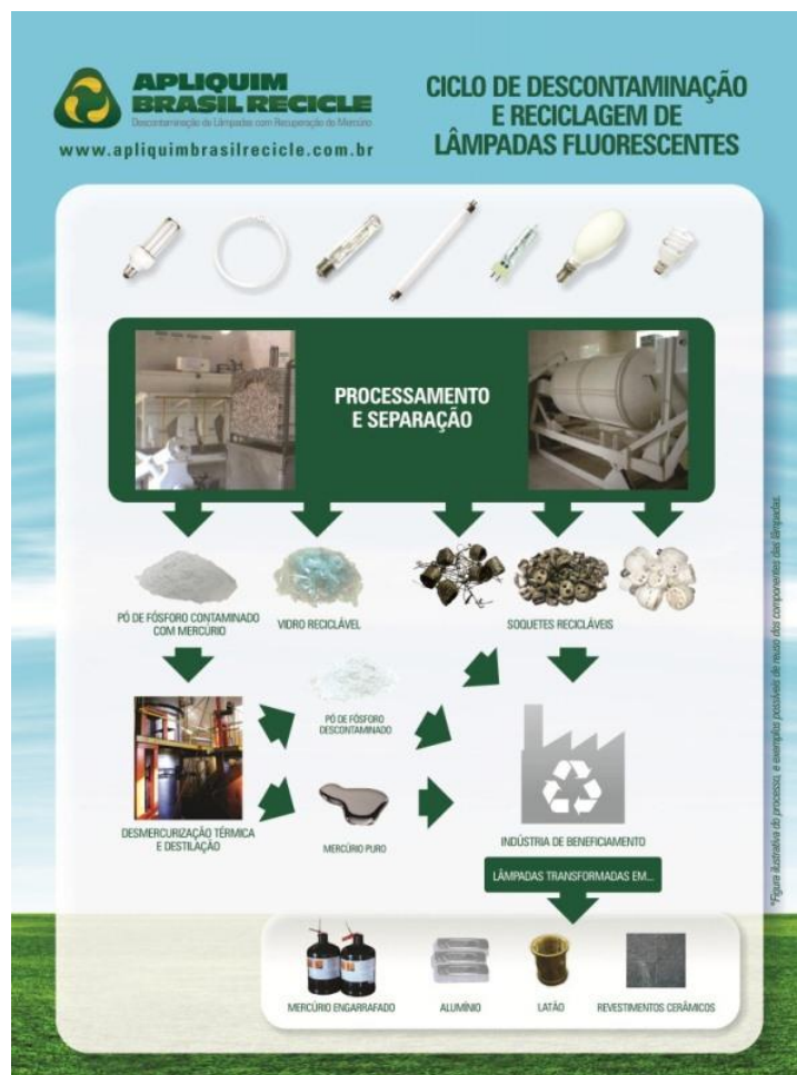
Figura 5: Fluxograma do processo de descontaminação de lâmpadas fluorescentes [21].
