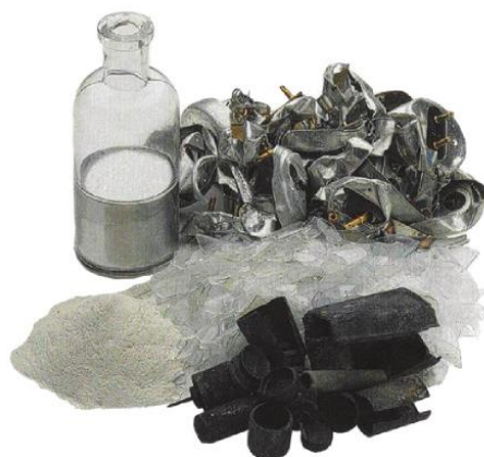
Figura 3: Componentes de uma lâmpada fluorescente [18].
