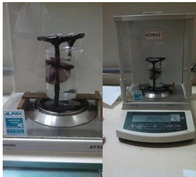
Figura 27: Aparato utilizado no ensaio de Arquimedes.
