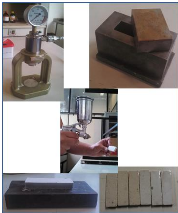
Figura 24: Produção dos corpos de prova para o ensaio de flexão.
