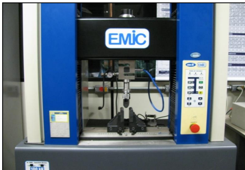
Figura 23: Aparelho utilizado no ensaio de flexão.
