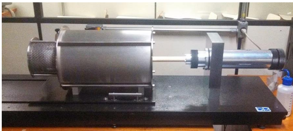
Figura 21: Equipamento de dilatação térmica do LPCM utilizado na análise.
