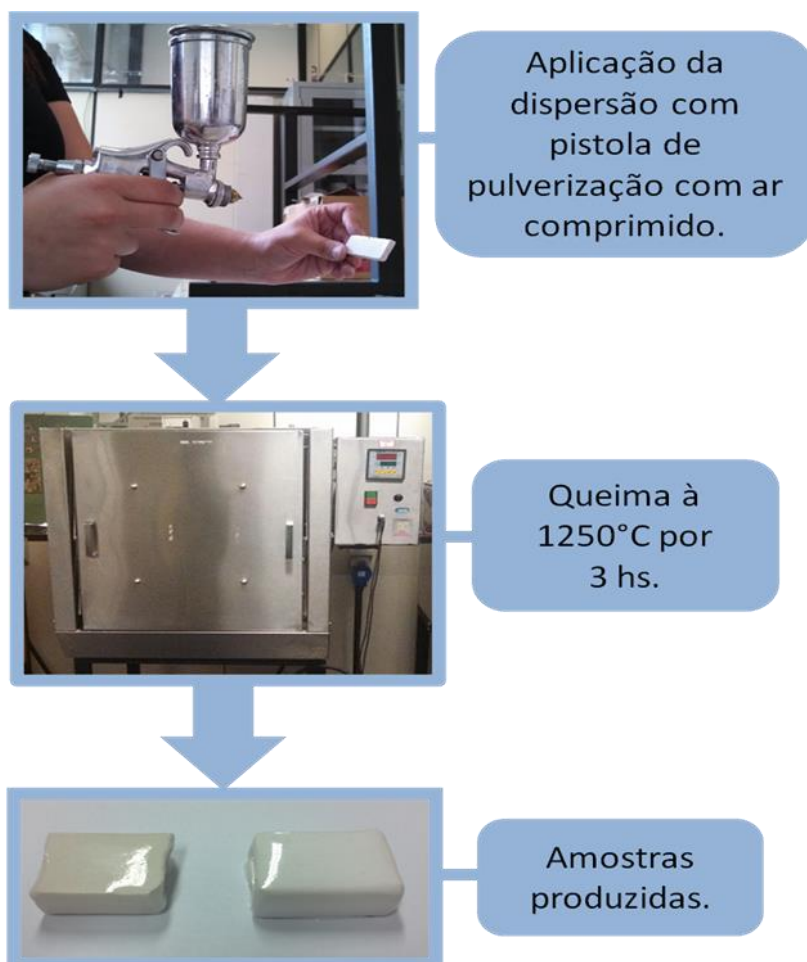
Figura 16: Fluxograma com as imagens das etapas de aplicação e obtenção dos vidrados com a incorporação do resíduo.
