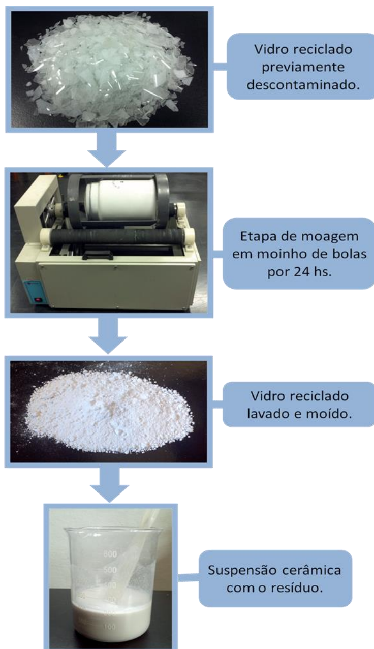
Figura 15: Fluxograma com as imagens das etapas de preparação da suspensão com o resíduo.
