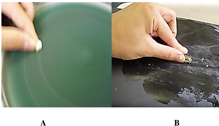
Figura 20 – Amostra sendo A lixada e B polida.
