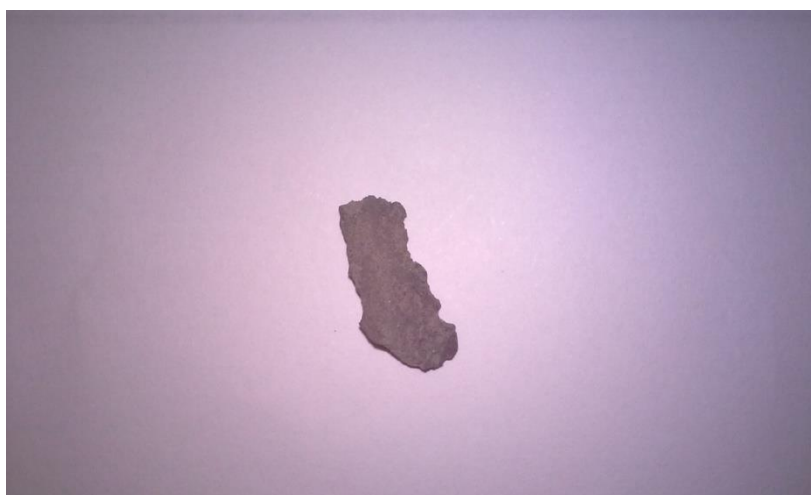
Figura 10 - Modelo de Corpo de Prova Utilizado na Análise por Cromatografia Gasosa
