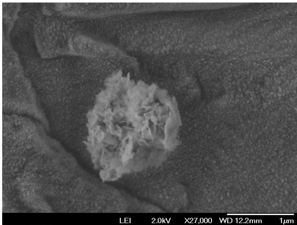
Figura 26 - Micrografia do Óxido de Magnésio sintetizado via Sol-Gel
