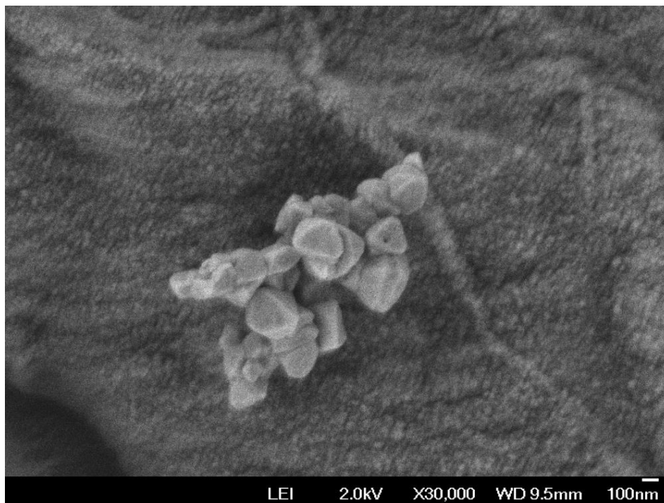
Figura 24 - Micrografia do Óxido de Magnésio sintetizado via Combustão
