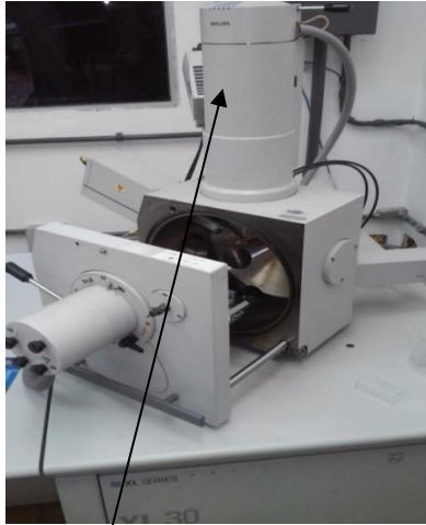
Figura 14 - Microscópio eletrônico e Varredura
