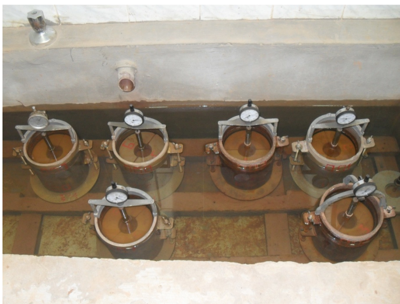
Figura 3.7 – Etapas do ensaio de expansão – Corpos de prova imersos Fonte: PROPRIEDADE DOS AUTORES (2013)
