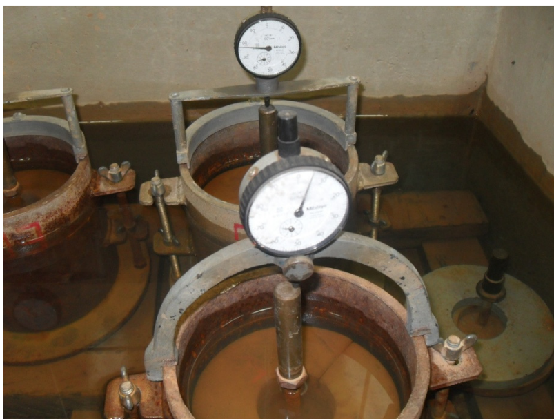
Figura 3.8 – Etapas do ensaio de expansão – Detalhe do extensômetro
