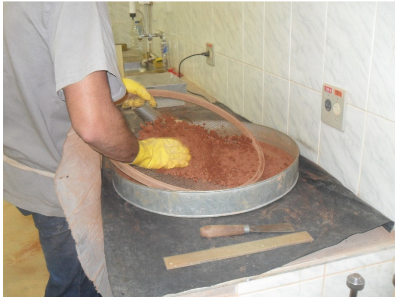
Figura 3.3 – Etapas do ensaio CBR – Peneiramento da amostra Fonte: PROPRIEDADE DOS AUTORES (2013)
