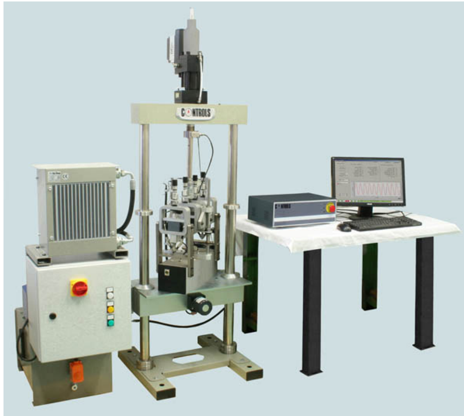
Figura 3.11 – Equipamento para realização de ensaios de fadiga em concretos asfálticos Fonte: PERTA (2012)
