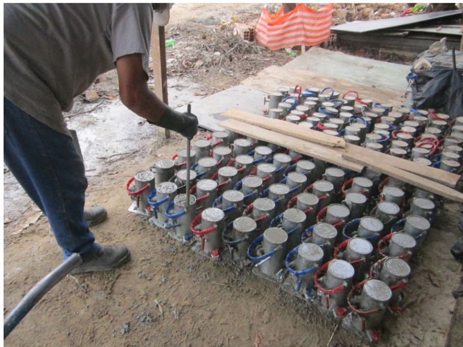
Figura 4.1 – Modelagem de corpos-de-prova com concreto para realização de Ensaio de Compressão Simples
