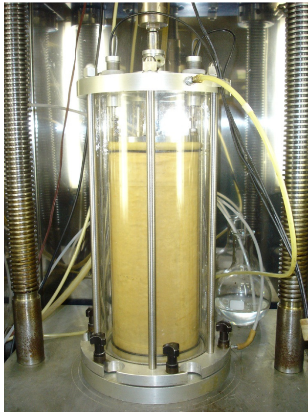
Figura 4.9 – Execução do ensaio de módulo de elasticidade Fonte: MOURA (2012)
