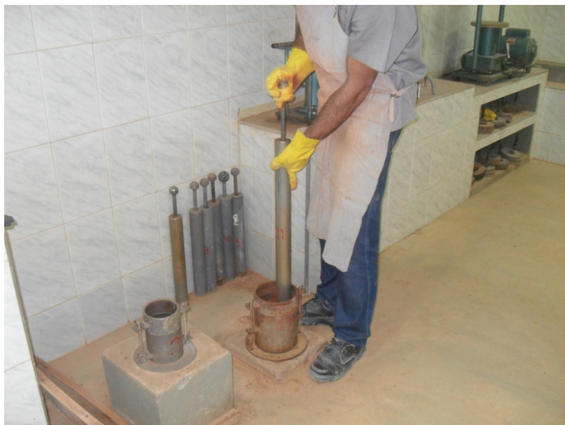
Figura 3.4 – Etapas do ensaio CBR – Moldagem do corpo de prova Fonte: PROPRIEDADE DOS AUTORES (2013)
