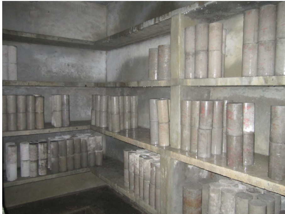
Figura 4.2 – Cura de corpos-de-prova de concreto para realização de Ensaio de Compressão Simples
