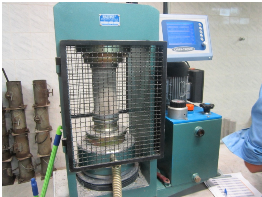
Figura 4.3 – Rompimento de corpo-de-prova de concreto em um Ensaio de Resistência à Compressão Simples
