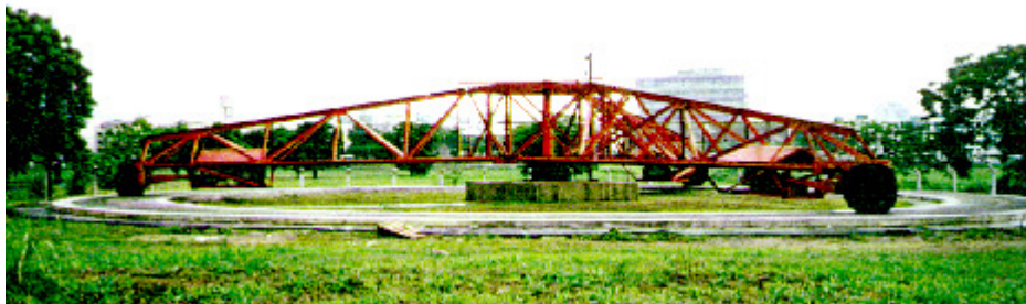
Figura 3.12 – Pista experimental para desenvolvimento de modelos de desempenho Fonte: DNIT (2006d)
