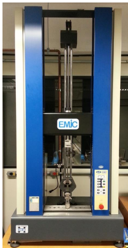
Figura 18: Máquina universal de ensaios modelo DL10.000, marca EMIC.
