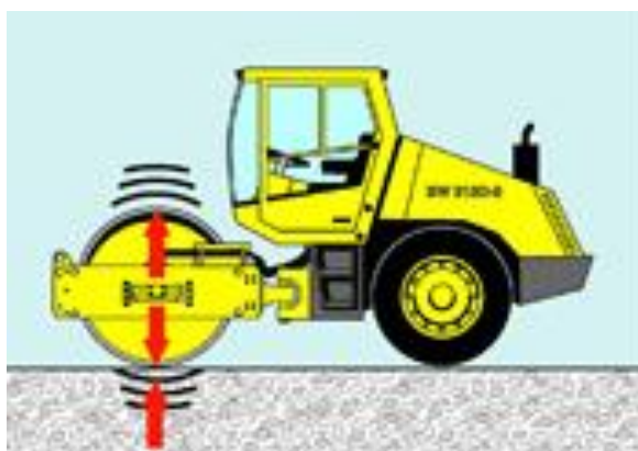
Figura 2.3: Sistema Vibratório (adaptado) Fonte: REVISTAMT (2011)
