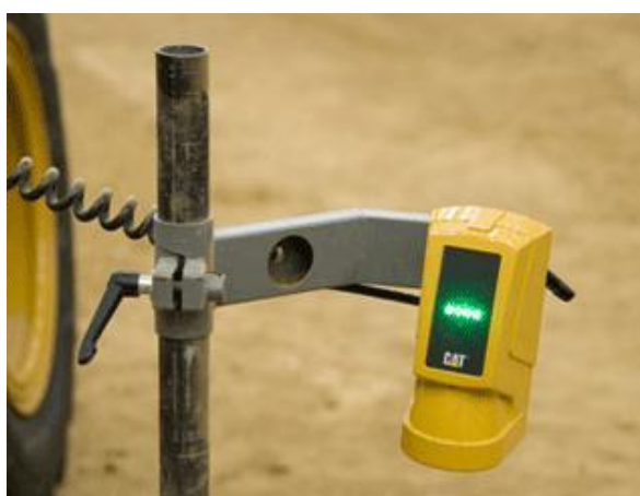
Figura 1.2: Sensor de Elevação da Superfície Fonte: CAT (2007)
