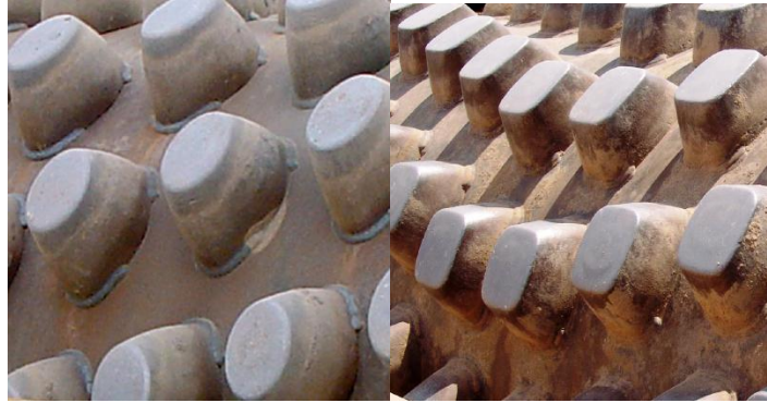
Figura 5.2: Fotos de Diferentes Patas de Rolos Pé de Carneiro Fonte: CAT (2007)
