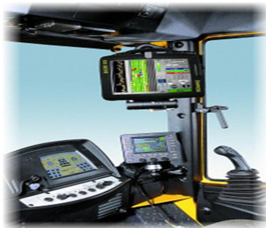
Figura 6.2: Cabine de Controle com Mapeamento de Pontos Críticos Fonte: BOMAG (2010)
