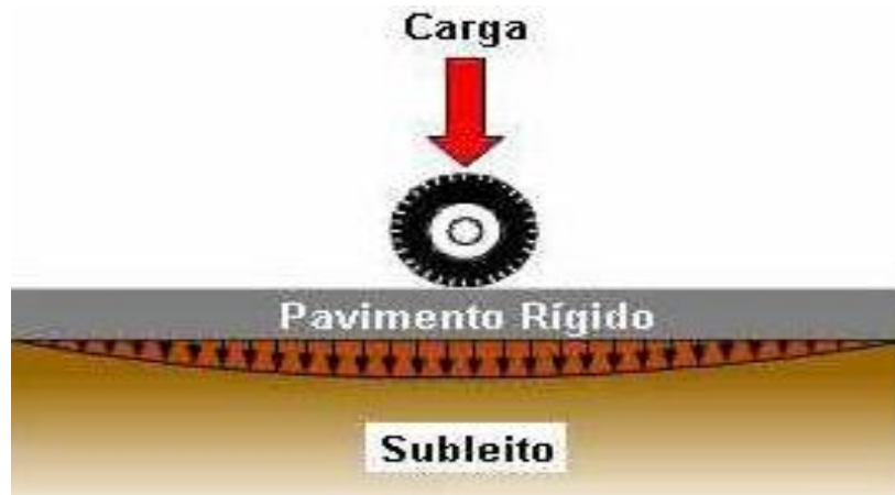
Figura 2.4 – Distribuição da carga no Pavimento Rígido Fonte: MOURA (2010, p.8)
