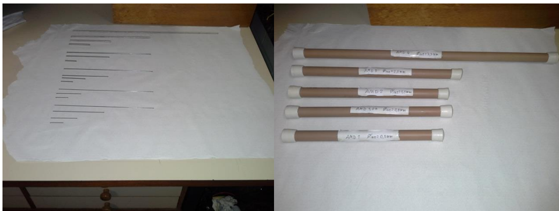
Figura 9: Capilares após a limpeza, à esquerda, e armazenados nos tubos de PVC, à direita.
