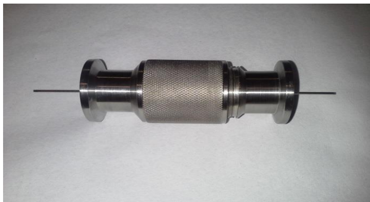
Figura 13: Imagem do engate rápido montado com o capilar posicionado.
