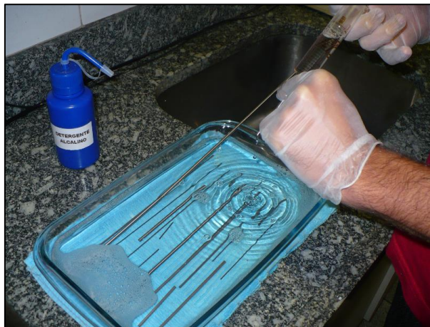
Figura 8: Processo de limpeza dos capilares.
