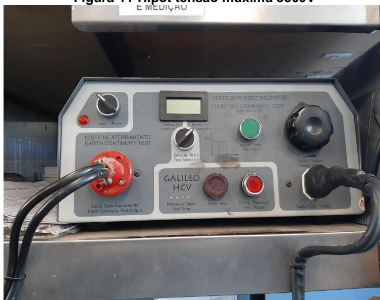
Figura 11 Hipot tensão máxima 3500V
