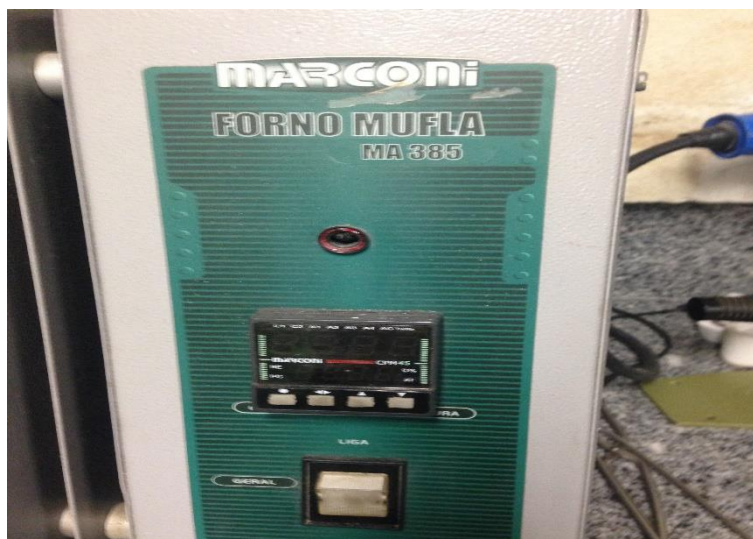
Figura 9 Forno mufla para sinterização do granítico
