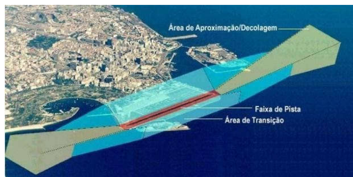
Figura 9 – Representação das superfícies limitadoras do PBZPA do Aeroporto Santos Dumont, Rio de Janeiro-RJ.
