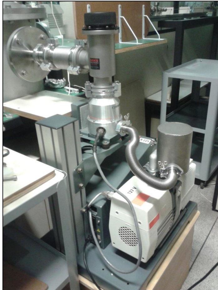
Figura 22: Bomba Turbomolecular Acoplada com Bomba Mecânica de Palhetas.
