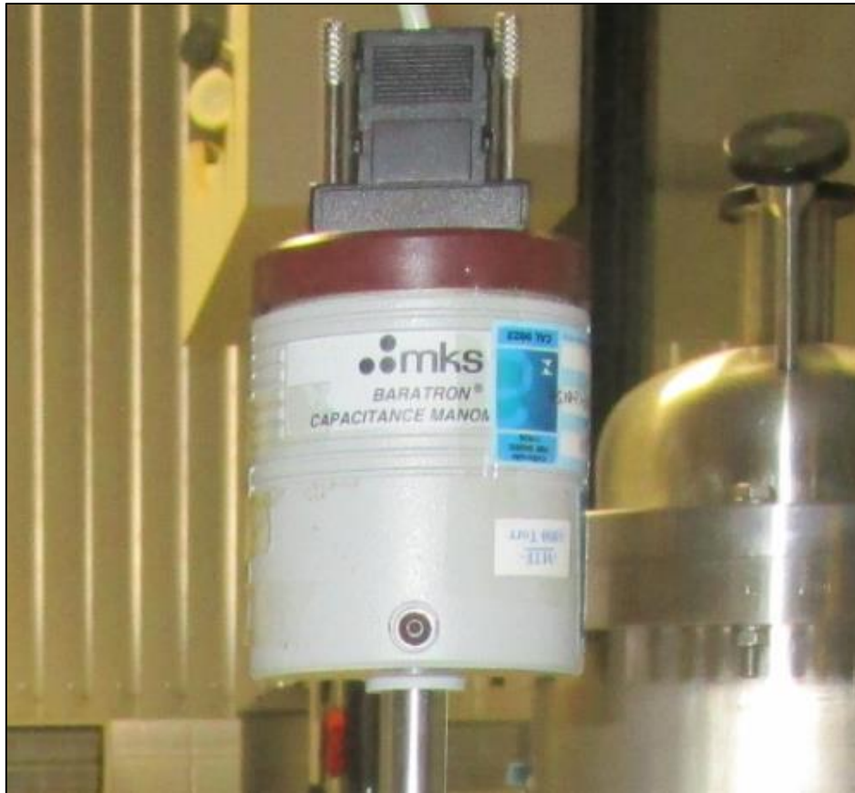
Figura 17: Medidor de membrana capacitiva BARATRON com fundo de escala de 1000 torr, resolução de 0,001 % F.S. e precisão de 0,25 % da leitura. (CORTESIA DA MKS).
