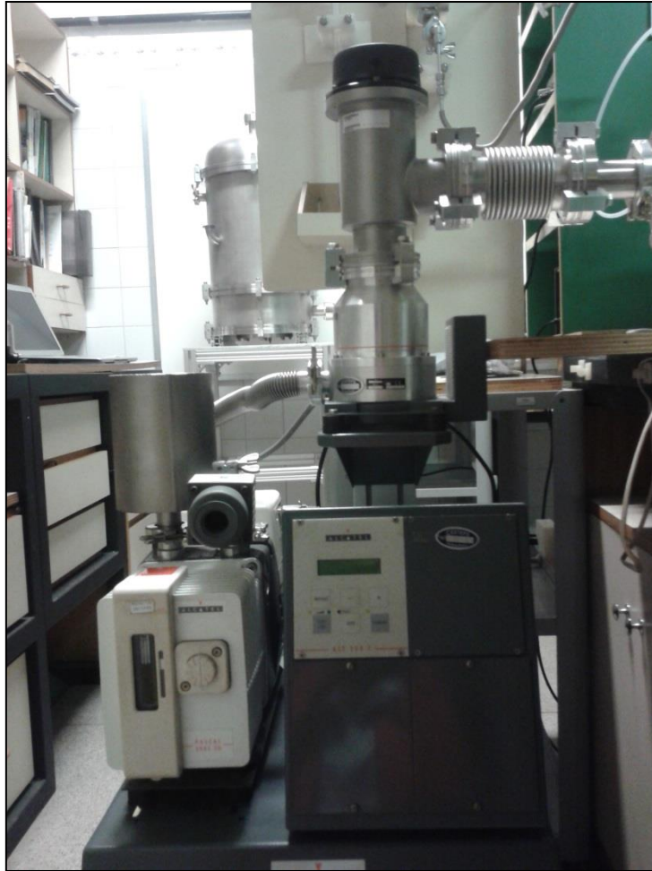
Figura 23: Bomba Mecânica de Palhetas (lado esquerdo da imagem) e Bomba Turbomolecular (lado direito da imagem)
