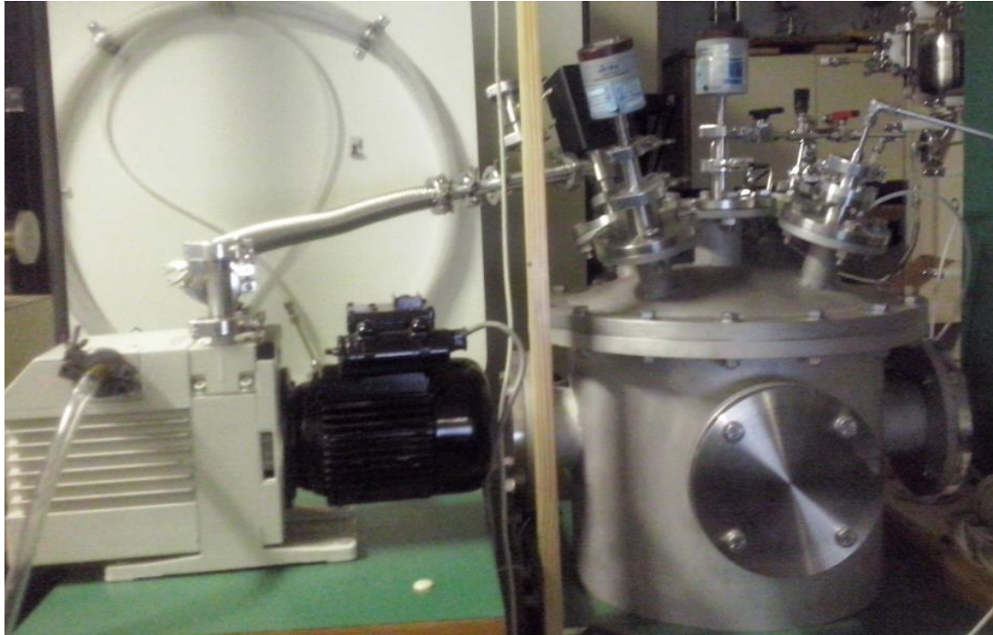
Figura 10: Foto do Sistema Montado de Verificação de Vazamentos
