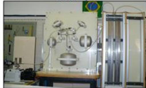
Figura 1- Sistema de vácuo para determinação de condutância, velocidade de bombeamento e fluxo de gases de misturas gasosas.
