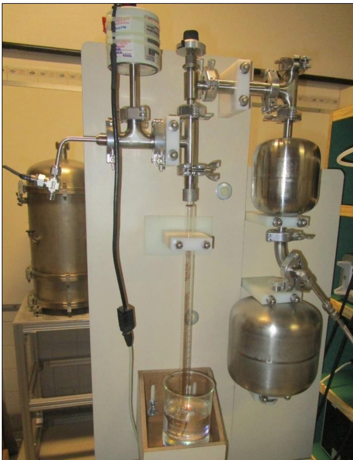
Figura 20: Foto do Sistema de Vácuo Utilizado Para o Método da Pipeta
