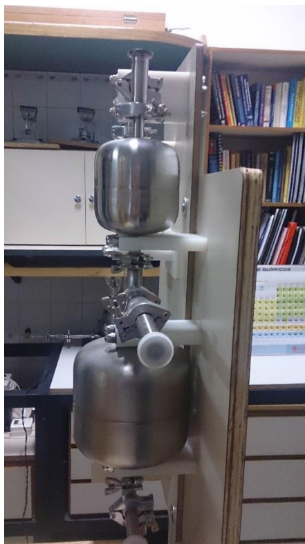
Figura 18: Base de sustentação do sistema de vácuo construída de madeira
