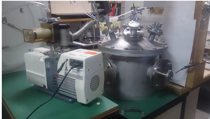
Figura 20: Estrutura de suporte para câmara de vácuo 02 (dois) e bomba mecânica de palhetas.
