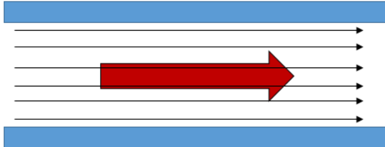
Figura 05: Regime de escoamento viscoso laminar
