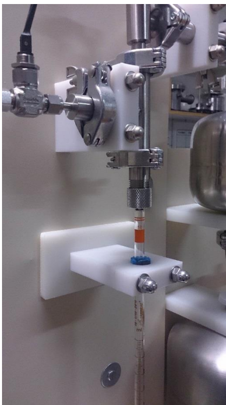
Figura 19: Suportes para conexões e câmaras de vácuo feitos em polímero.
