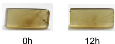
Figura 3.17 – BWT - U1: 2% em peso \text{Er}_2\text{O}_3 e 1% em peso \text{Au}_2\text{O}_3 , com diferentes tempos de tratamento.
