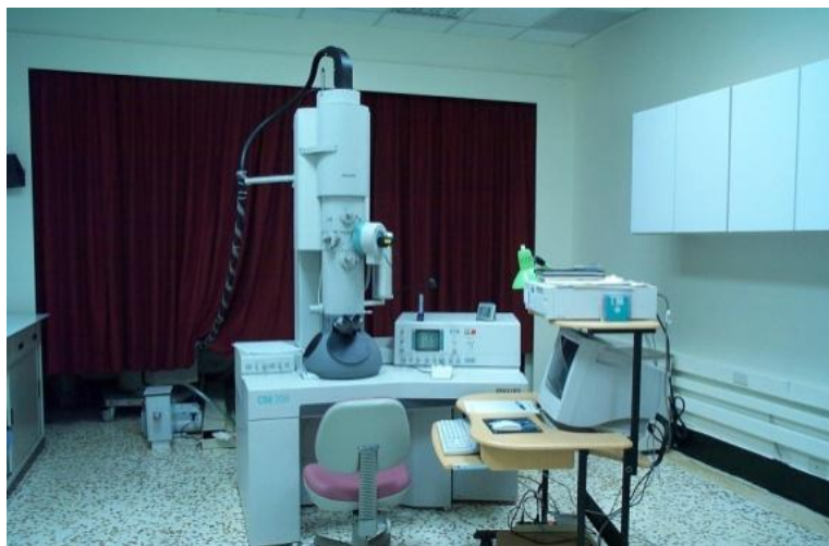
Figura 3.22 – Microscópio Eletrônico de Transmissão que pode ser utilizado para analisar nanopartículas metálicas [70].
