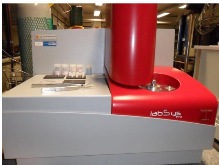
Figura 3.23 – Calorímetro de exploração diferencial do Laboratório de Materiais da Faculdade de Tecnologia de São Paulo [70].
