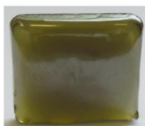
Figura 3.16 – BWT - D6: 1% em peso Tb_4O_7 , 3% em peso Yb_2O_3 e 1% em peso Au_2O_3 .
