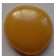
Figura 3.13 – BWT - D3: 2% em peso Tb_4O_7 e 5% em peso Yb_2O_3 , após a refusão.
