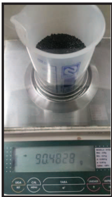
Figura 17: Pesagem do GAC ( M_{gac(2)} ), retirado do filtro químico nº 2
