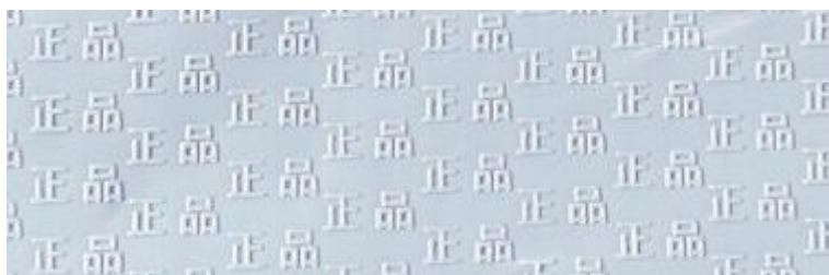
Figura 15 :A mensagem gravada na memória de forma do filme-etiqueta polimérico após a ativação.
