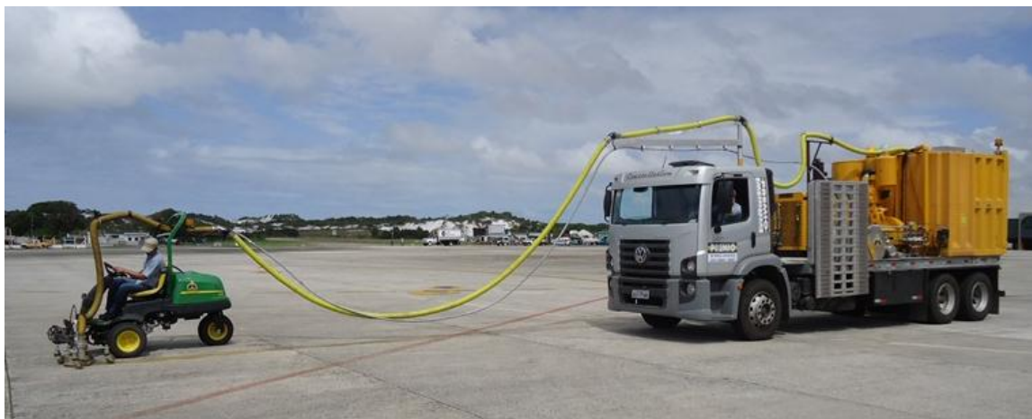
Figura 5.7 – Caminhão utilizado no processo de desemborrachamento de pista Fonte: JANINO (2013)
