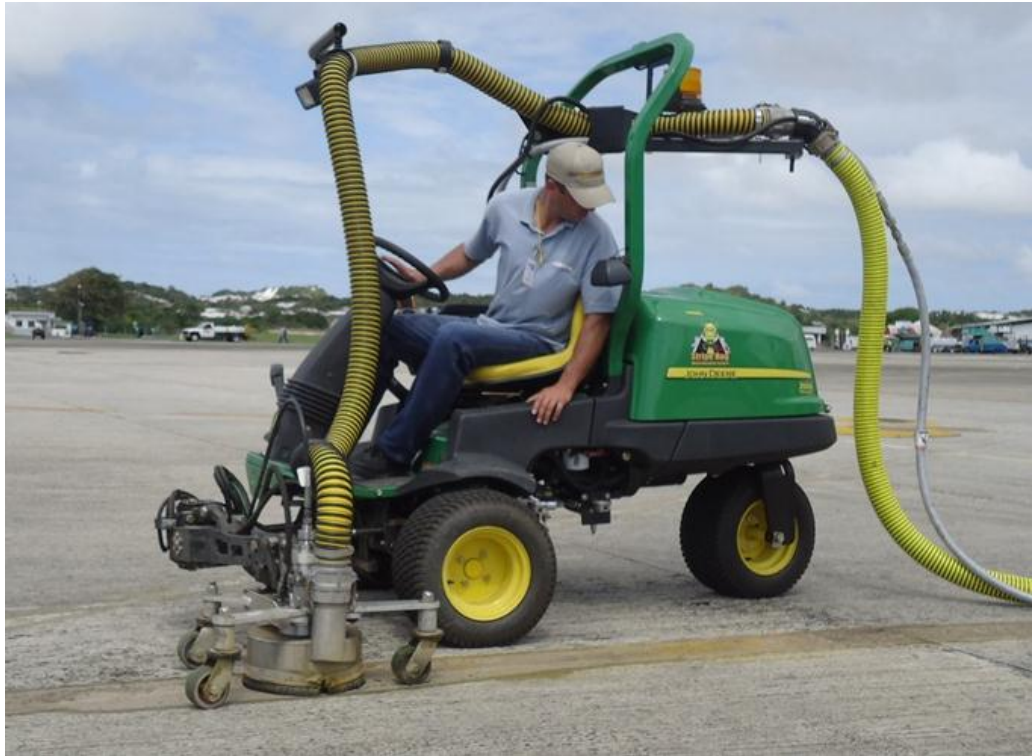
Figura 5.8 – Processo de desemborrachamento no Aeroporto Internacional Afonso Pena. Fonte: JANINO (2013)
