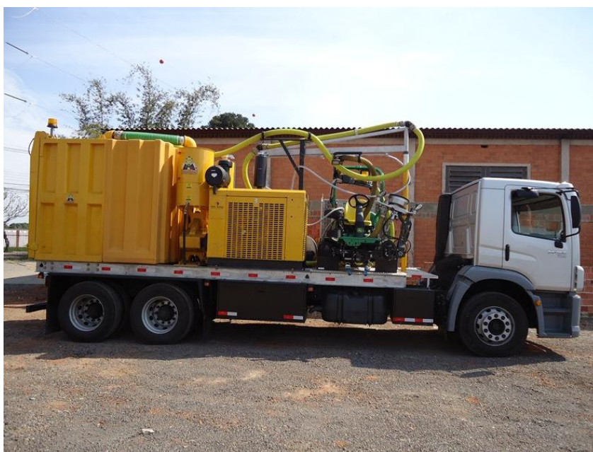
Figura 5.6 – Caminhão utilizado no processo de desemborrachamento de pista Fonte: JANINO (2013)
