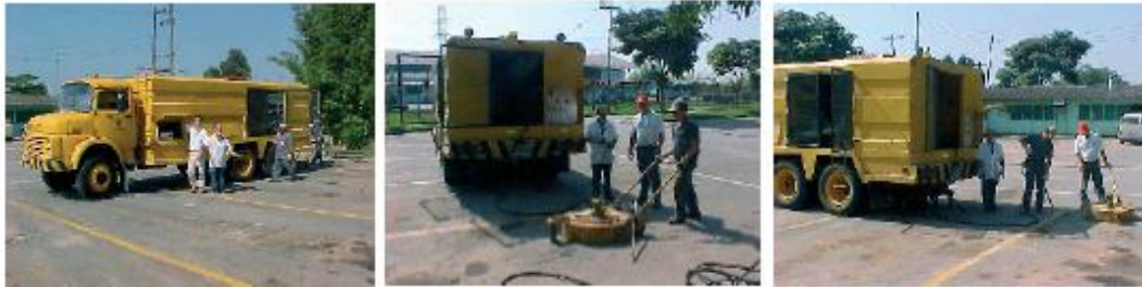
Figura 5.2 – Caminhão WOMA com bomba para hidrojateamento.
