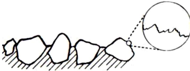
Figura 2.8 – Modelo de superfície com macrotextura aberta e microtextura áspera Fonte: SANZONE (2006)
