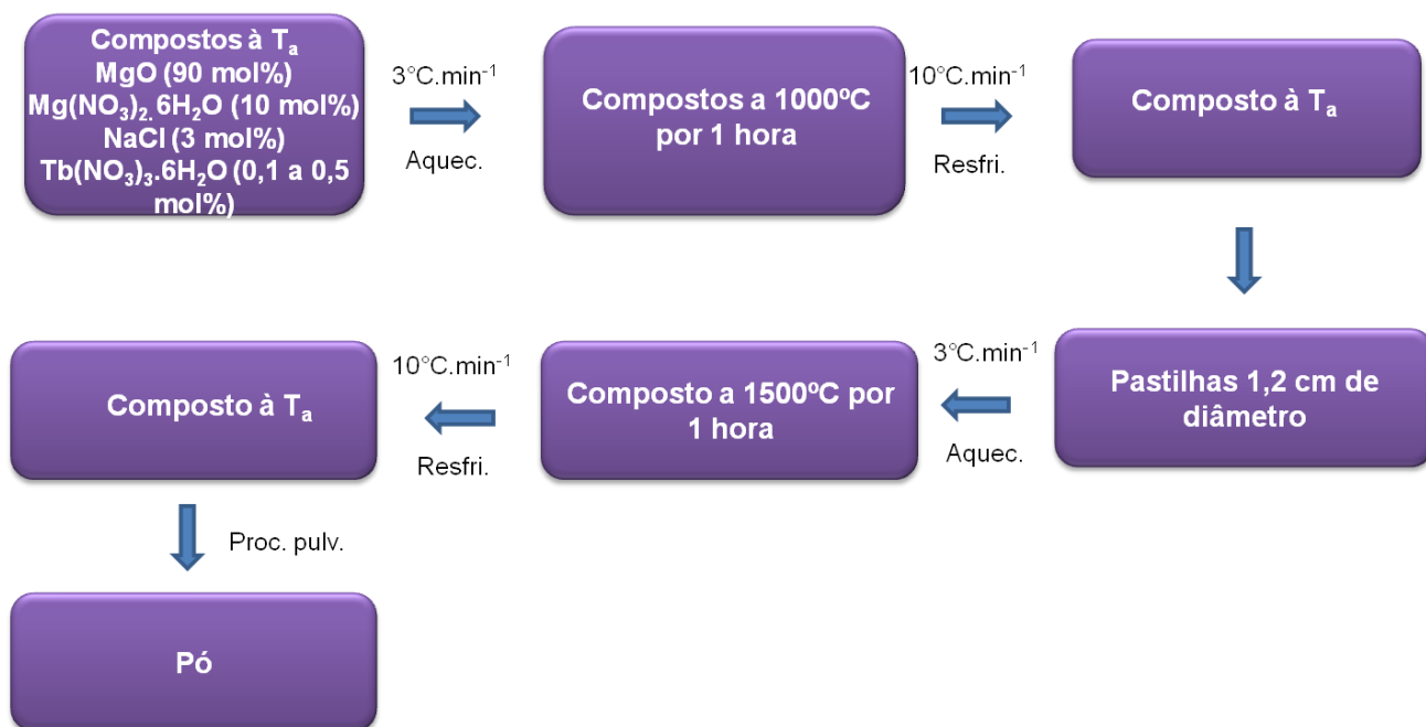
Figura 7: Fluxuograma do preparo do pó de MgO:Tb através da técnica de pirólise.
