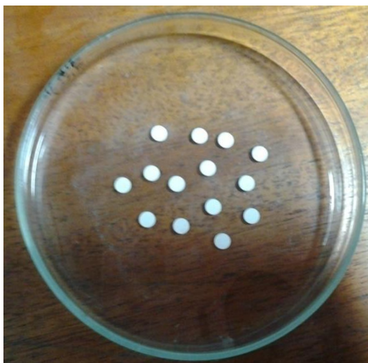
Figura 35: Pastilhas de MgO dopadas com diferentes concentrações de cobre em mol% utilizadas para medidas TL.
