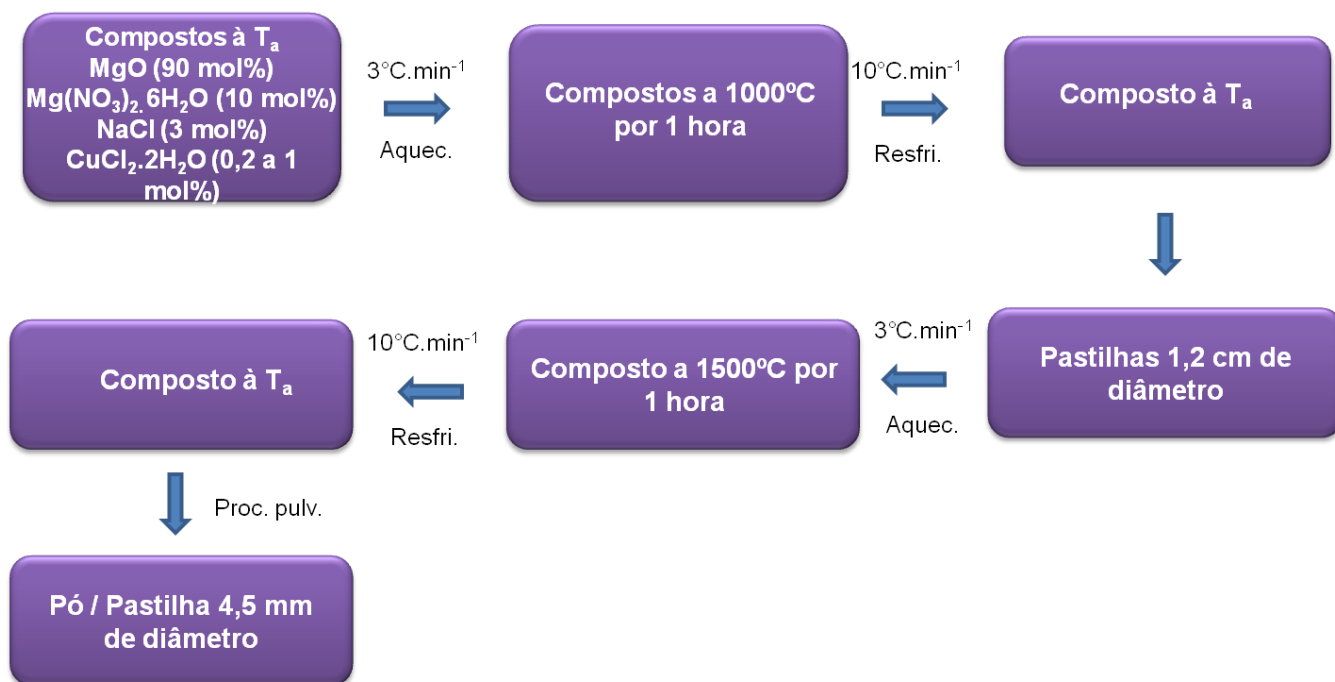
Figura 9: Produção de \text{MgO}:\text{Cu} através da técnica de pirólise.
