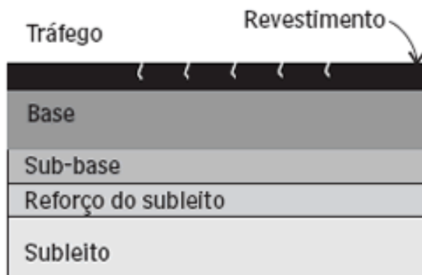
Figura 2.1: Representação das camadas do pavimento Flexível Fonte: GOUVEIA 2012
