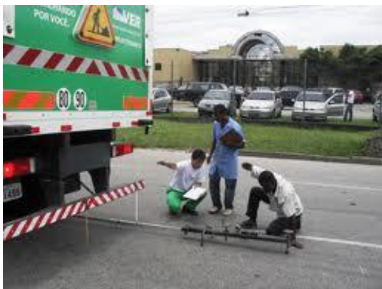
Figura 1.3: Viga Benkelman Fonte: DNIT (2011)
