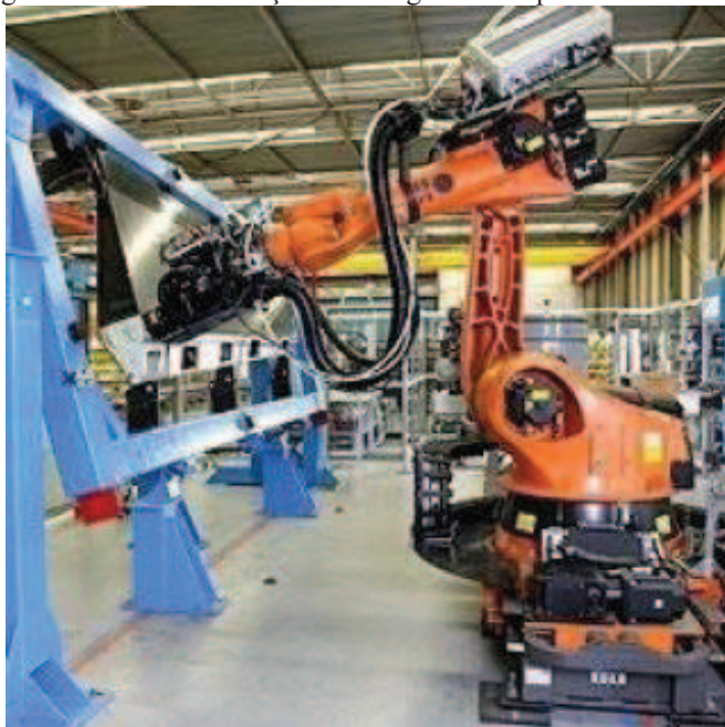
Figura 23 - Robô de furação e rebitagem na empresa Stork-Fokker
