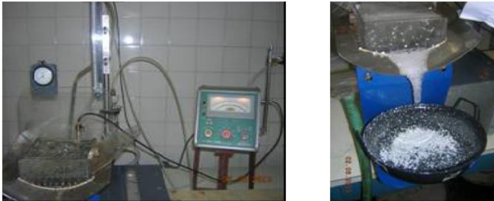
Figura 40: Montagem laboratorial para flutuação por espumas.
