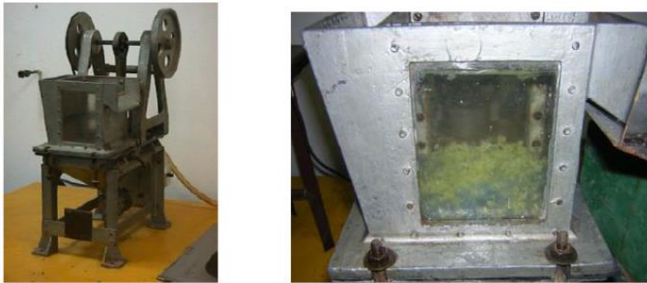
Figura 36: Equipamento laboratorial usado na jigagem.
