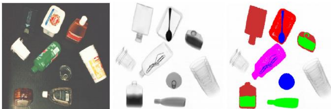
Figura 33: Imagens obtidas por raios-X usadas na separação de materiais plásticos de outros resíduos não – plásticos.
