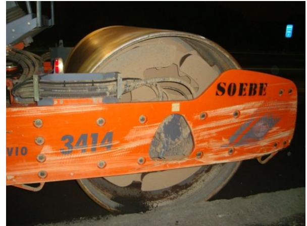
Compactação com rolo liso vibratório
