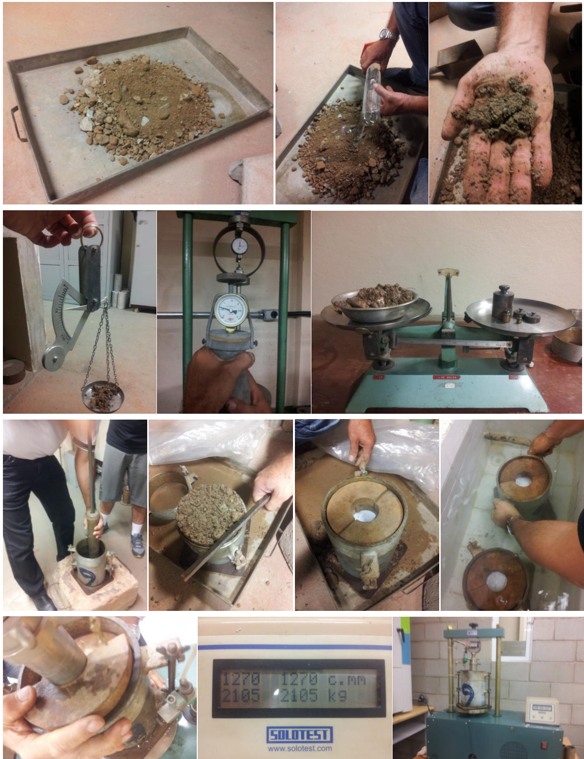
Figura 4.2 – Ensaio de I.S.C. RCD Fonte: Bienemann (2013)
