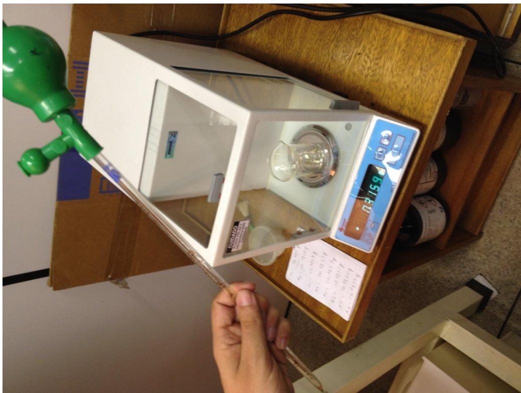
Figura 19: Pipeta, pera de sucção, balança e béquer para as medições das massas das gotas.
