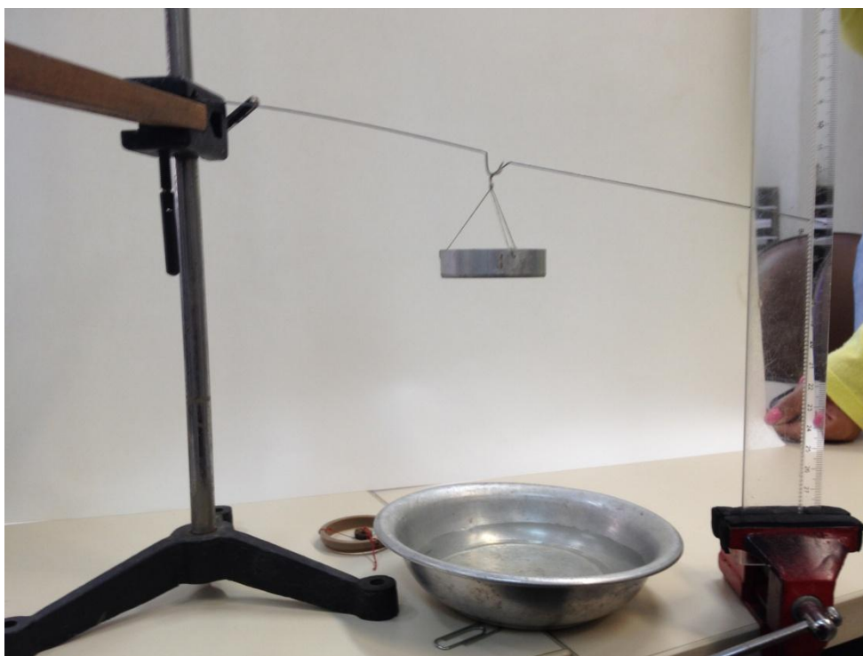
Figura 20: Arranjo experimental para o método do anel.
