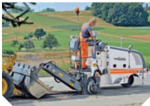
Figura 2.21 – Fresadora W 350 E, da Wirtgen Fonte: WIRTGEN (2011)
