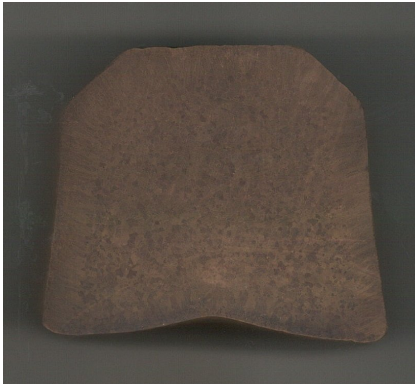
FIGURA 33 -MACROGRAFIA DO LINGOTE FUNDIDO DA LMF
