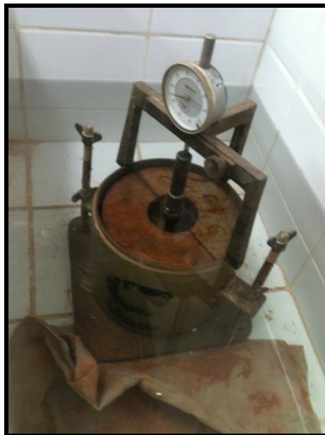
Figura 4.29 – Corpo-de-prova imerso na água Fonte: PRÓPRIA (2014)
