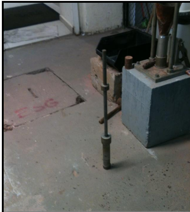
Figura 4.22 – O soquete Fonte: PRÓPRIA (2014)
