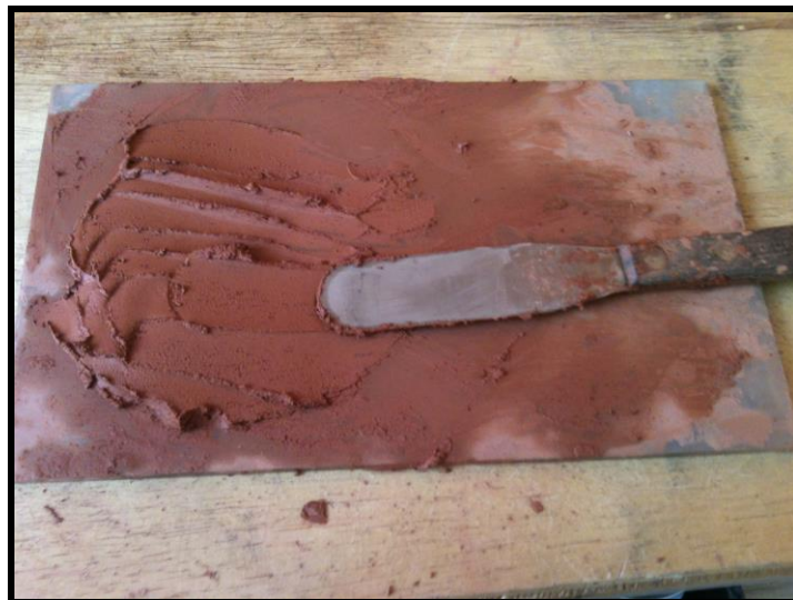
Figura 4.12 – Amostra homogeneizada Fonte: PRÓPRIA (2014)
