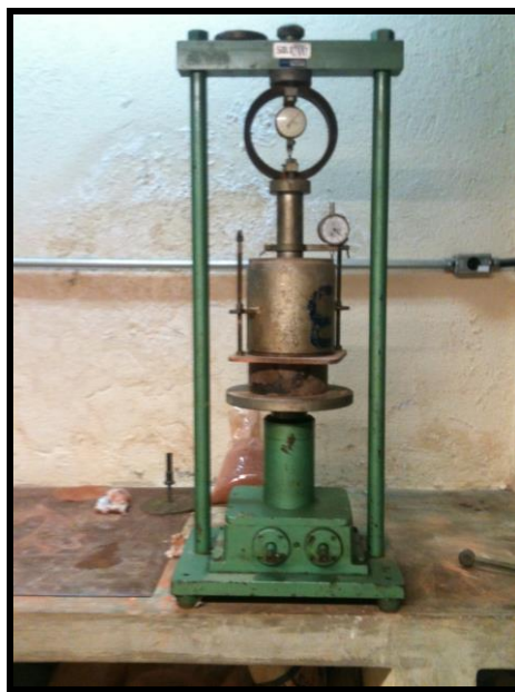
Figura 4.32 – Prensa do ISC manual Fonte: PRÓPRIA (2014)
