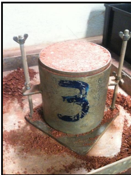
Figura 4.28 – O excesso removido Fonte: PRÓPRIA (2014)
