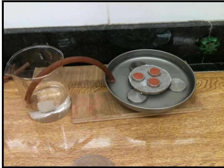
Figura 4.16 – As pastilhas absorvendo a água Fonte: PRÓPRIA (2014)
