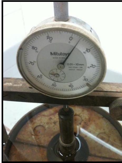
Figura 4.30 – Extensômetro Fonte: PRÓPRIA (2014)
