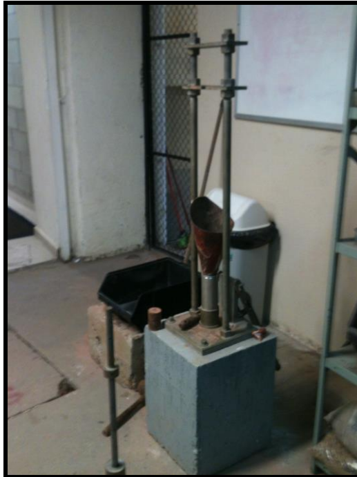
Figura 4.20 – O aparelho compactador com o molde do corpo de prova Fonte: PRÓPRIA (2014)
