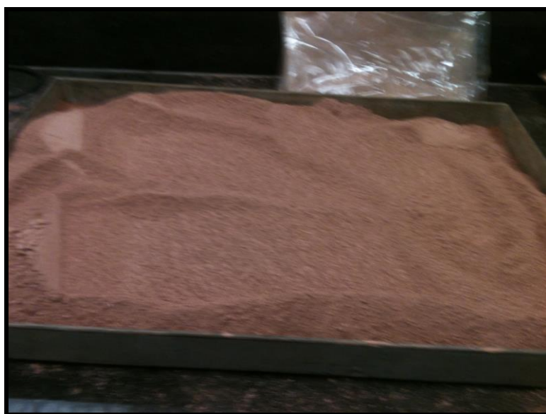
Figura 4.40 – A mistura solo-cal homogeneizada Fonte: PRÓPRIA (2014)
