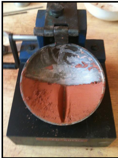
Figura 4.6 – Aparelho Casagrande com a amostra Fonte: PRÓPRIA (2014)
