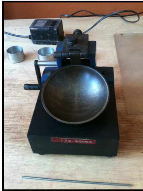
Figura 4.5 – Aparelho Casagrande Fonte: PRÓPRIA (2014)
