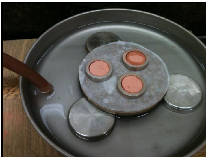
Figura 4.15 – As pastilhas começando absorver a água Fonte: PRÓPRIA (2014)
