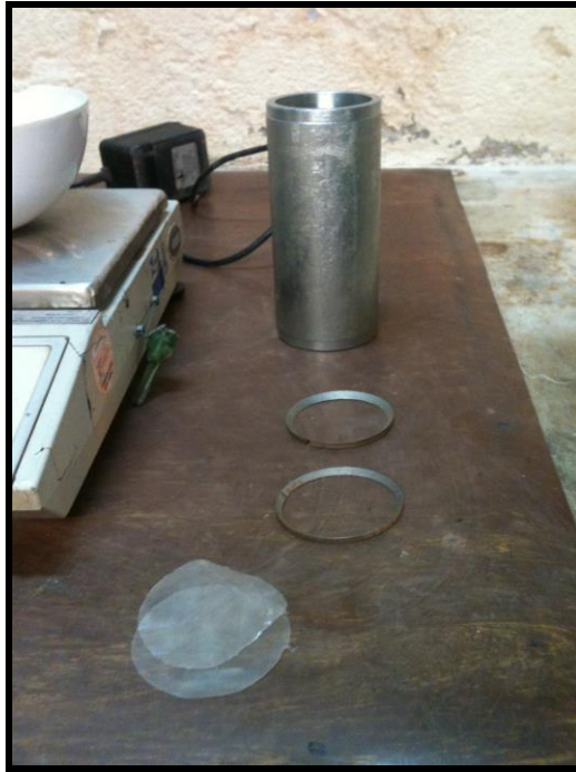
Figura 4.21 – O molde do corpo de prova, o anel de vedação e a folha de polietileno Fonte: PRÓPRIA (2014)
