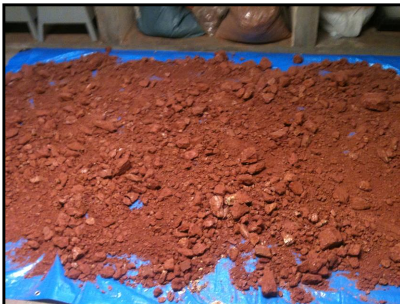
Figura 4.1 – Amostra do solo antes de ser peneirada Fonte: PRÓPRIA (2014)
