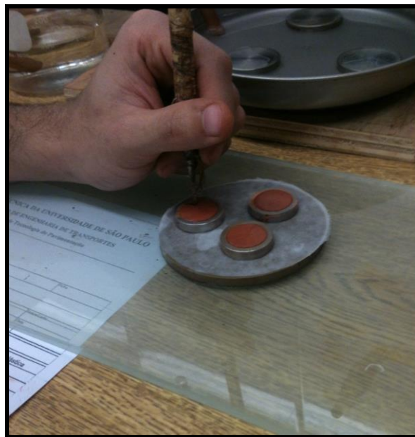
Figura 4.17 – Penetração das pastilhas Fonte: PRÓPRIA (2014)
