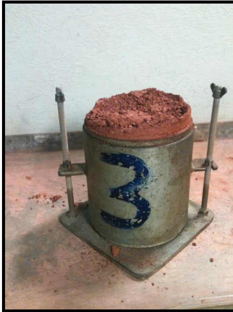
Figura 4.27 – Excesso acima do cilindro Fonte: PRÓPRIA (2014)
