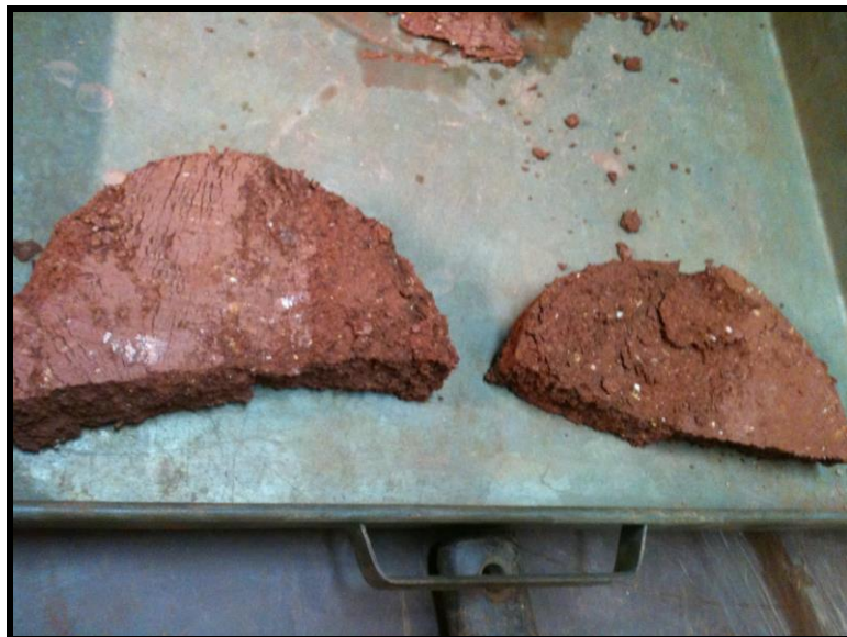
Figura 4.36 – Dividindo o corpo de prova para a determinação da umidade ótima Fonte: PRÓPRIA (2014)
