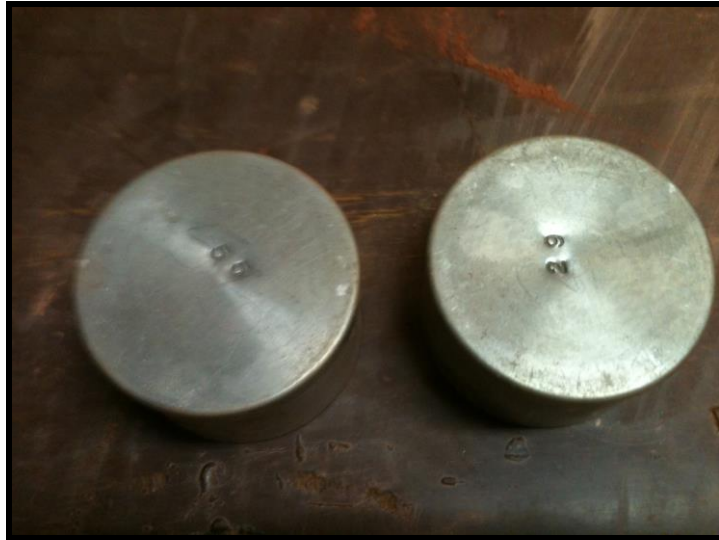
Figura 4.8 – Cápsula com a amostra para a determinação da umidade ótima Fonte: PRÓPRIA (2014)
