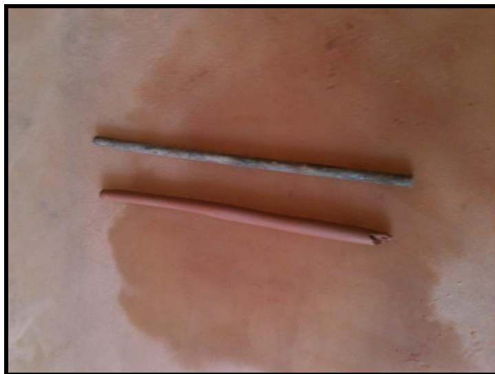
Figura 4.9 – Cilindro com diâmetro de aproximadamente 3 mm Fonte: PRÓPRIA (2014)
