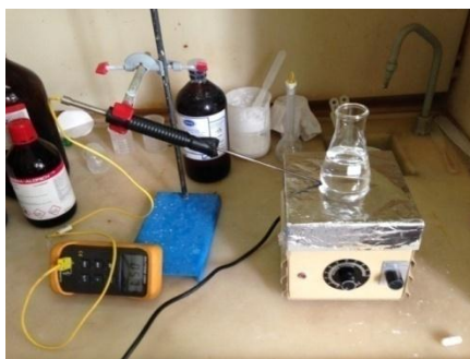
Figura 3-4: Agitador magnético com chapa aquecedora, barra magnética (peixinho), termopar e solução de hidróxido de sódio.
