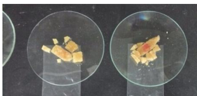
Figura 3-20: Compósito após a quebra do corpo de prova.
