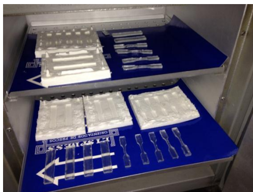
Figura 3-8: Moldes fabricados em silicone para produzir corpos de prova, e amostras produzidas com a resina.
