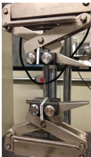
Figura 3-14: Fibra rompida após o ensaio de tração.
