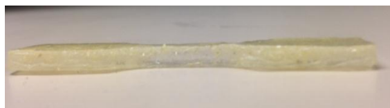
Figura 3-25: Corpo de prova com fibras somente em sua parte superior.
