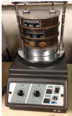
Figura 3-2: Peneiramento das fibras em um agitador eletromagnético Bertel BT-001.
