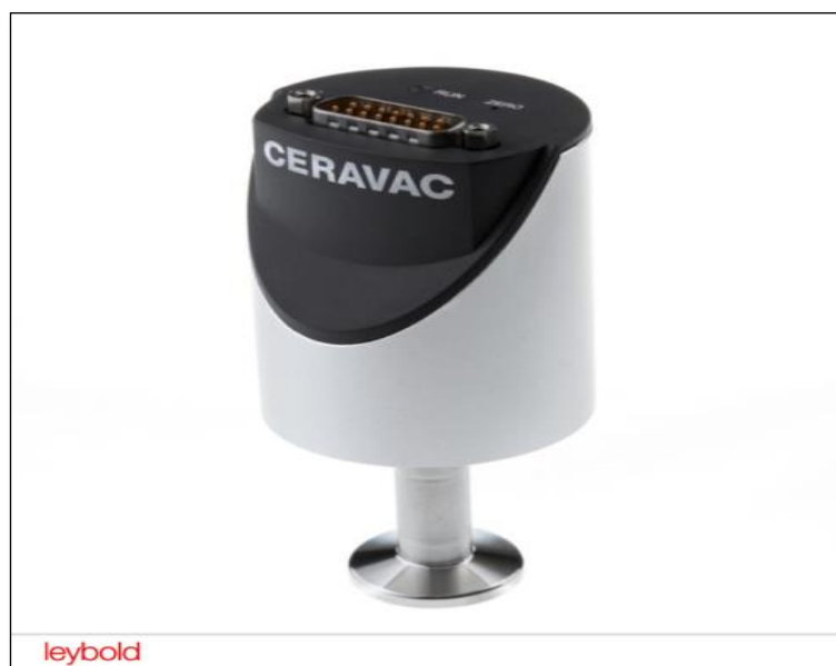
Figura 9 Medidor de membrana capacitiva CERAVAC com fundo de escala de 100 torr e 1000 torr, resolução de 0,003 % F.S. e precisão de 0,15 % da leitura. ( CORTESIA DA LEYBOLD).
