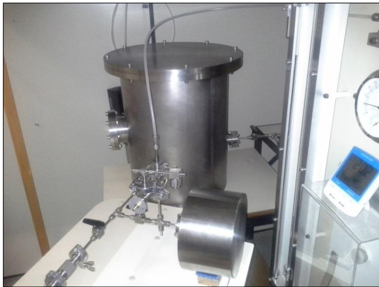
Figura 16 Câmara de vácuo de (56 \pm 1) L feita com aço inoxidável.
