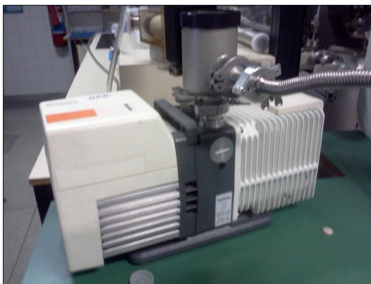
Figura 18 Bomba de pré-vácuo Pascal 2010, SD version, 1-phase motor, 180-254 V, 50 Hz/60 Hz com velocidade de bombeamento de 2,92 \text{ l.s}^{-1}
