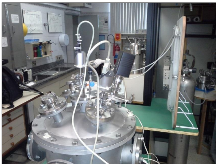
Figura 16 Câmara de vácuo de (56 \pm 1) L feita com aço inoxidável.
