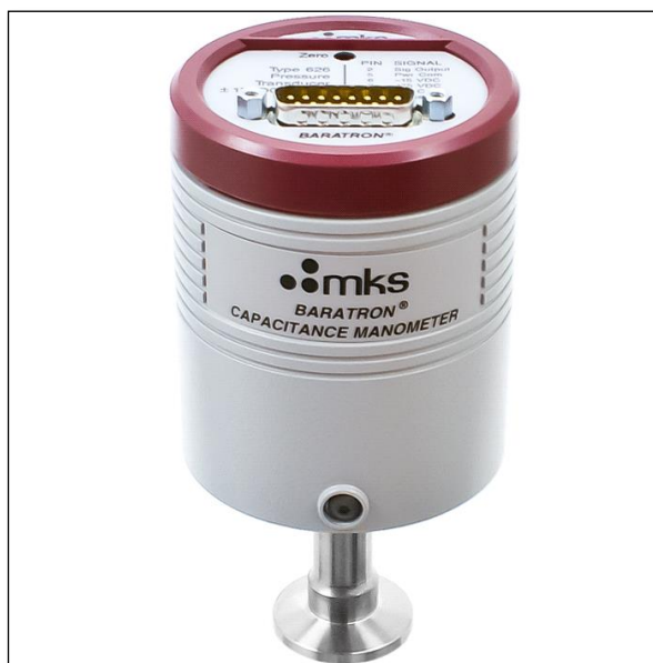
Figura 10 Medidor de membrana capacitiva BARATRON com fundo de escala de 1000 torr, resolução de 0,001 % F.S. e precisão de 0,25 % da leitura. (CORTESIA DA MKS).
