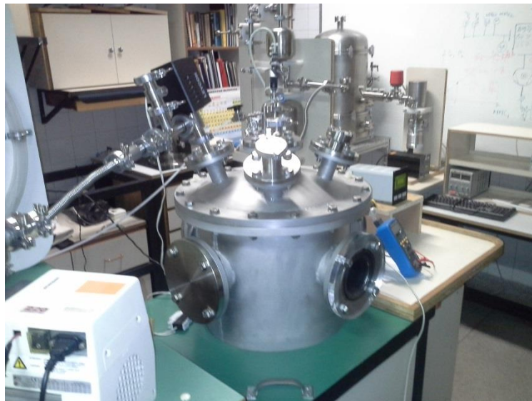
Figura 24 Foto da câmara de vácuo 2 e dos componentes para aquisição eletrônica dos dados de pressão e tempo do sistema de vácuo 3
