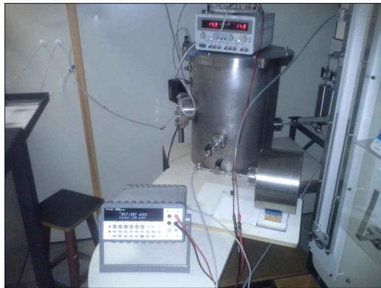
Figura 15 Multímetro de bancada da Minipa modelo MDM-8165(em cima da bancada) fonte da Minipa modelo MPC 3003D (em cima da câmara de vácuo)
