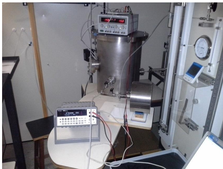
Figura 23 Foto da câmara de vácuo 1 e dos componentes para aquisição eletrônica dos dados de pressão e tempo do sistema de vácuo 3.
