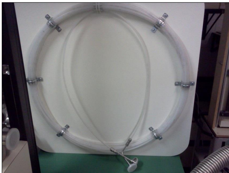
Figura 12 Tubo feito de polietileno com 30 m de comprimento e 4,35 mm de diâmetro.
