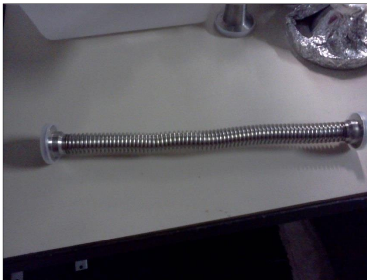
Figura 13 Fole metálico com 30 cm de comprimento e 2,5 cm de diâmetro.
