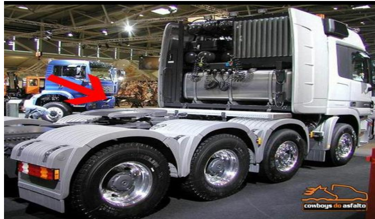
Figura 2.24 – Quinta roda localizada no cavalo do caminhão
