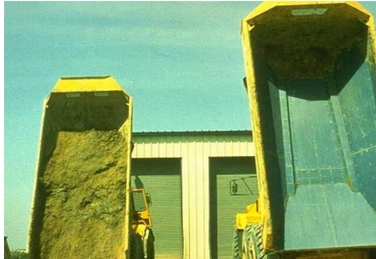
Figura 2.14 - Caminhão sem revestimento e com revestimento de PEUAM
