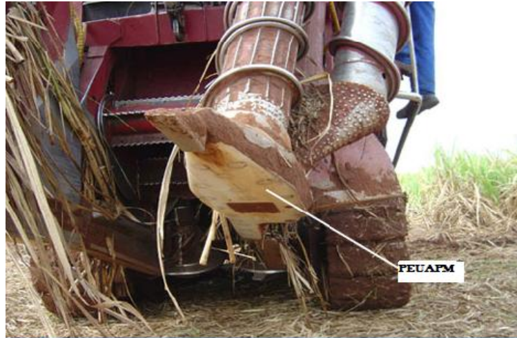
Figura 2.21 - Equipamento Agrícola com PEUAPM
